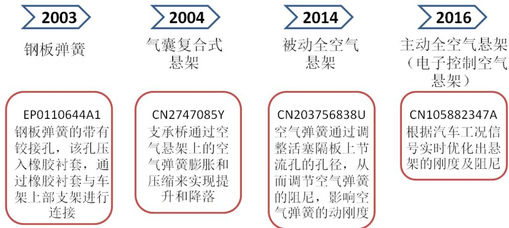
图 4-34 汽车零部件发展路线图
